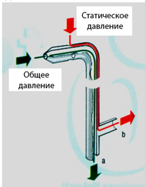
Рисунок 14 – Измерение давление с помощью трубки Прандтля
