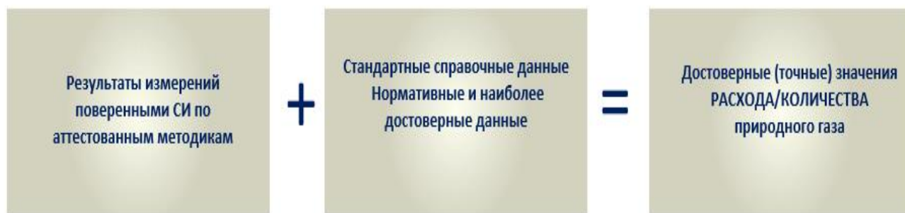
Рисунок 2 – Схема определения расхода и количества природного газа
