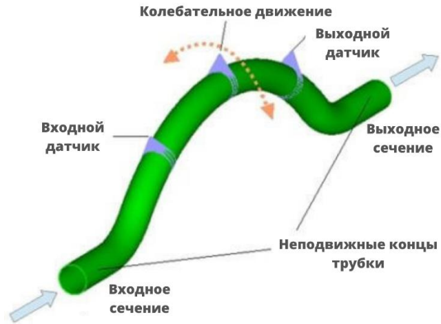
Рисунок 25 – Измерительная трубка
